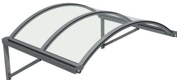
Pensilina ideale per proteggere infissi e porte d'ingresso con sopraluce tondo. I profili laterali con funzione di grondaia supportati da puntoni permettono la raccolta dell'acqua piovana ed il convogliamento allo scarico frontale.
